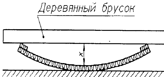
Рисунок Б.3 - Измерение отклонения от плоскостности плиты
